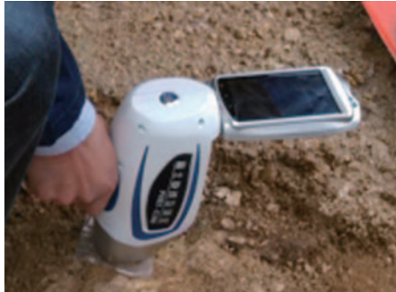
南方离子型稀土矿现场检测结果 (REO : 0.01%~0.1%)
